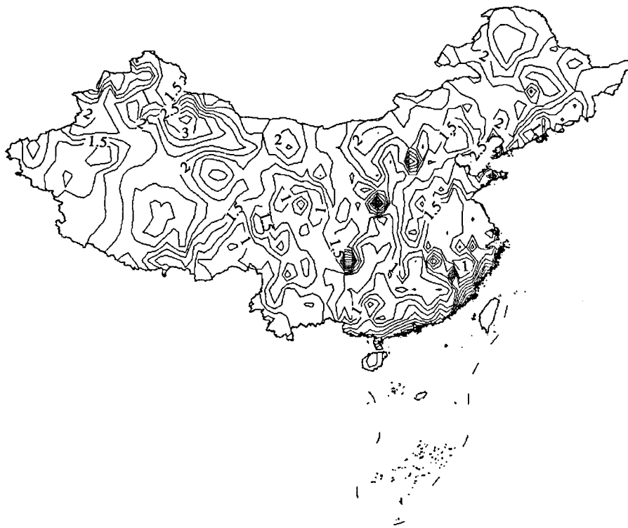
图 5 我国大陆地区(不包括港、台和领海海域)年最大平均风速的标准差等值线分布图 Fig. 5 Contour of variance of yearly maximum average wind speed in mainland of China
