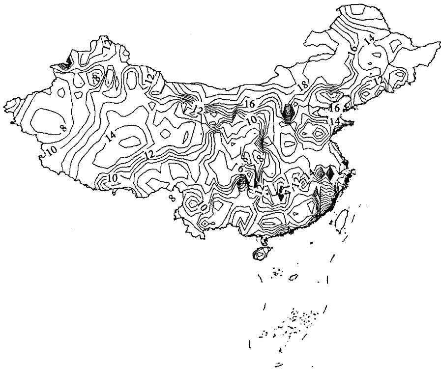
图 4 我国大陆地区(不包括港、台和领海海域)年最大平均风速的均值等值线分布图 Fig. 4 Contour of mean value of yearly maximum average wind speed in mainland of China
